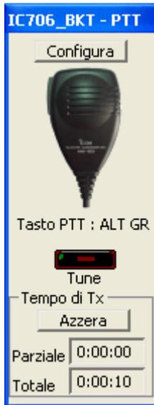
E' possibile gestire il PTT da PC solo se è disponibile un'interfaccia per modi digitali, oppure, se è stato costruito il semplice [circuito](#) riportato sopra. Cliccare sul microfono per commutare in trasmissione/ricezione, oppure, premere il tasto scelto nella [configurazione](#).
