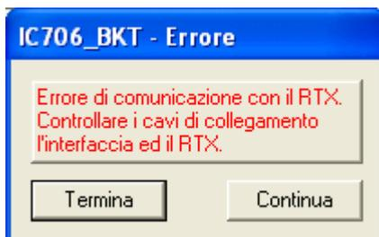
Questo messaggio appare se è stato superato il tempo di timeout prima della risposta del RTX a un
