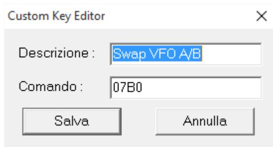
L'editor permette di personalizzare il custom key con la descrizione a piacere e il comando da inviare. I comandi vanno inseriti in esadecimale e sempre con un numero di caratteri pari, esempio per il comando 7 inserire 07.
