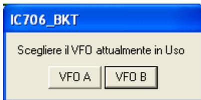
Non è possibile leggere attraverso l'interfaccia CI-V il VFO attualmente in uso, per cui è necessario indicarlo manualmente premendo sul relativo tasto.
