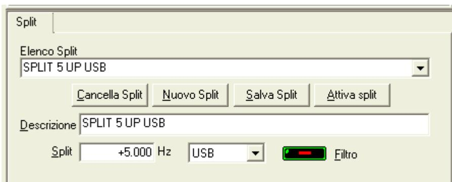
Permette di preimpostare gli split, cioè, la possibilità di ricevere e trasmettere su due frequenze diverse all'interno della stessa banda. Con il tasto [Attiva split] viene calcolato lo sfasamento della frequenza in uso ed impostata sul secondo VFO che sarà utilizzato solo in trasmissione. Per disattivare lo Split utilizzare il relativo tasto sulla [maschera principale](#).
