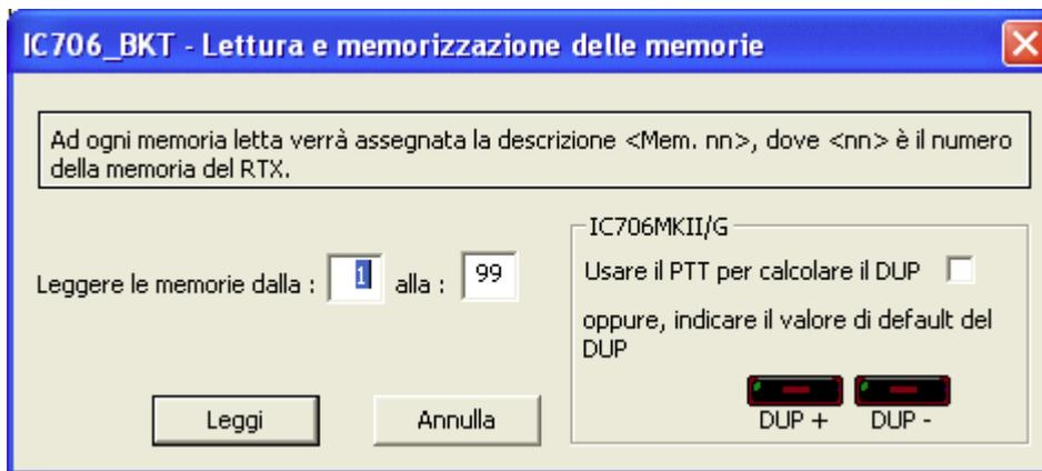
E' possibile leggere sequenzialmente le memorie del RTX e trasferirle nel database di IC706\_BKT. Visto che non è possibile leggere il nome delle memorie, ad ogni memoria letta verrà assegnato il nome Mem [nn] dove nn è il numero della memoria. Per il modello IC706MKII/G è possibile indicare un'impostazione predefinita per il DUP, oppure se è stata attivata la funzione PTT nella configurazione del programma, è possibile calcolare automaticamente il DUP mandando il RTX in trasmissione.
