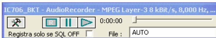
L'AudioRecorder permette di registrare direttamente dal RTX al PC. Per un corretto funzionamento bisogna collegare la scheda audio del PC con il RTX (vedere [collegamento](#)), è anche molto importante una giusta scelta del CoDec da utilizzare per la registrazione (vedere [configurazione audio](#)).
